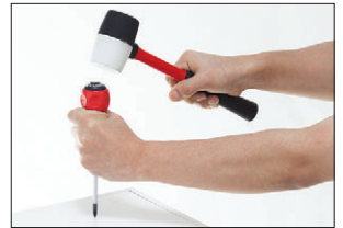
TKU-1又はTKU-2の使用時に天面にハーフパンチ穴をあける場合は所定の位置にドライバーを充てがいハンマーでたたき、穴をあけてください。
